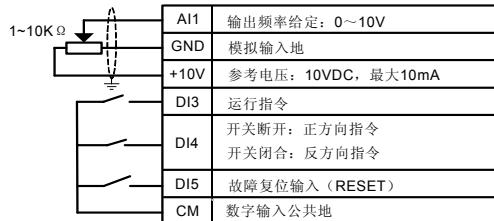
图 7-2-B 两线控制二 AI1 设定接线图
