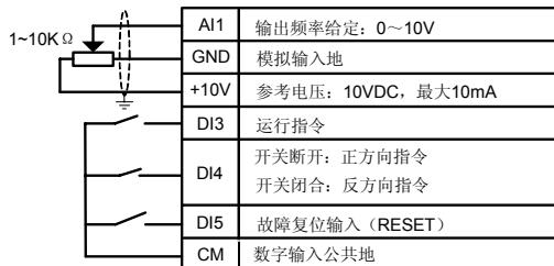
图 7-2-A 两线控制—AI1 设定接线
